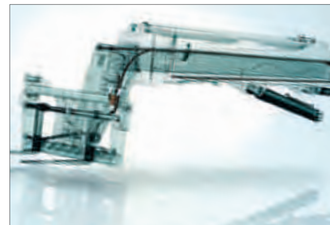
Шланги проложены внутри стрелы
