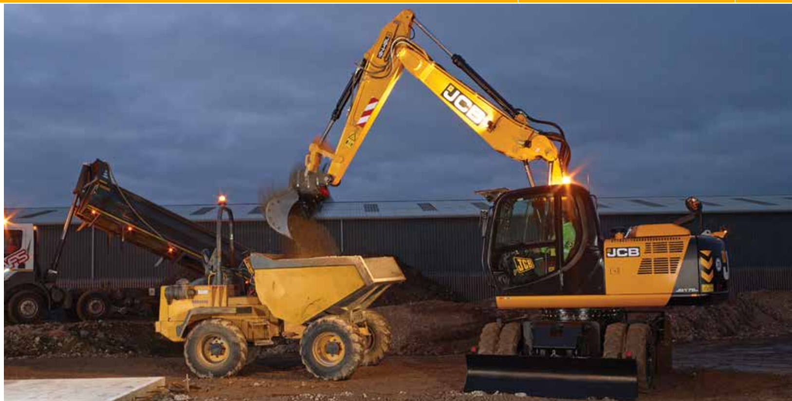
Предусмотрено применение одно- или двухсекционной стрелы.
