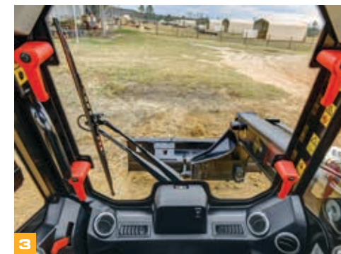
Мини-погрузчик с бортовым поворотом JCB — обзорность 270°
