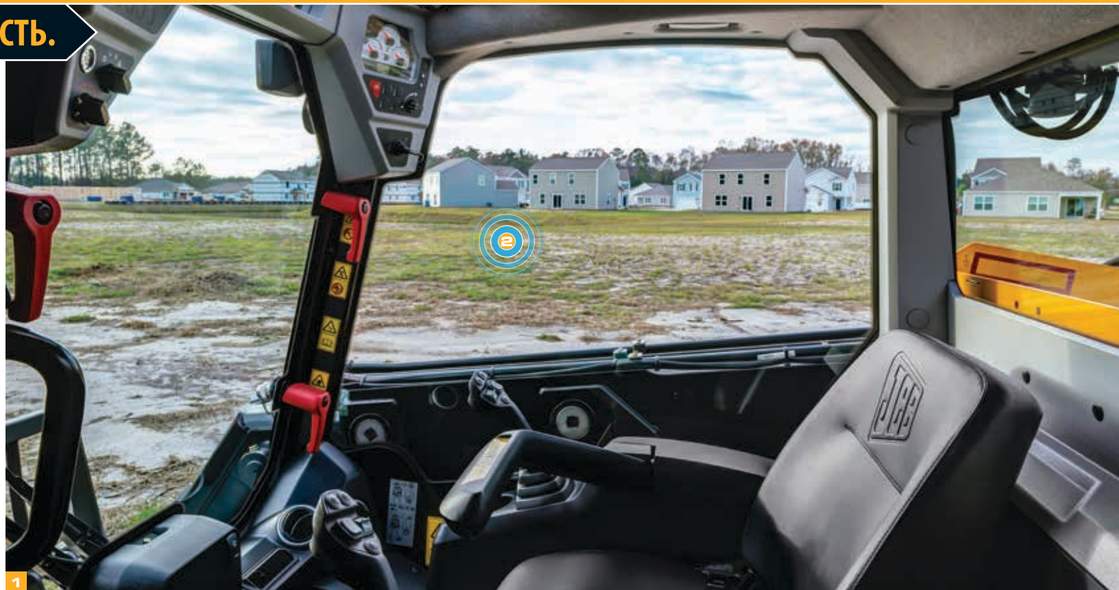
Обычный мини-погрузчик с бортовым поворотом — обзорность 165°
