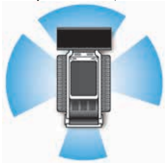
Обычный мини-погрузчик с бортовым поворотом — обзорность 165°
