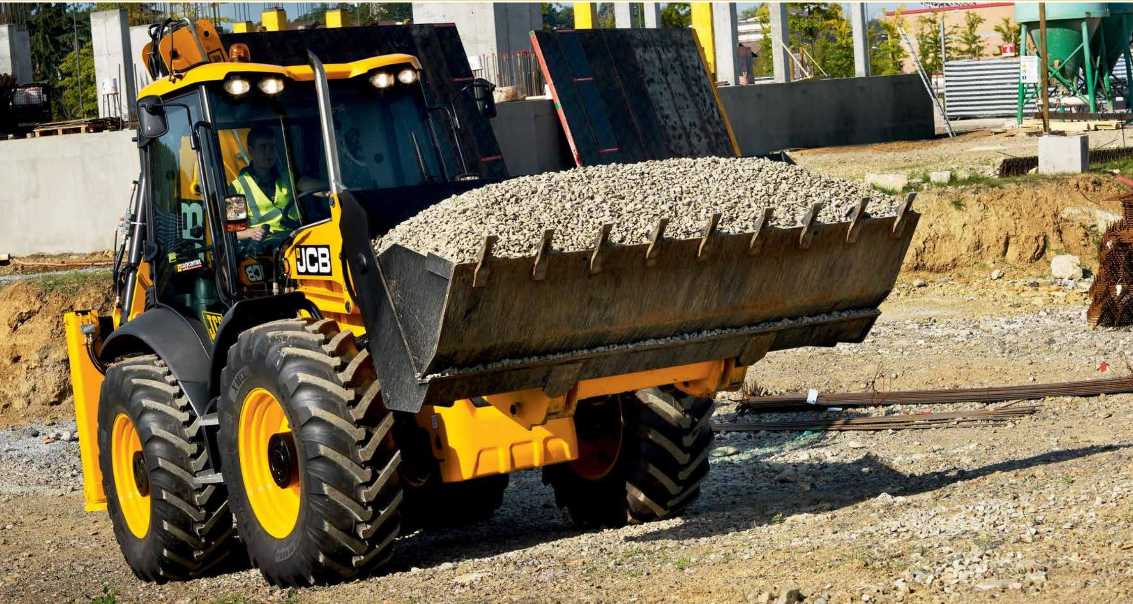
МАКС. МОЩНОСТЬ ДВИГАТЕЛЯ 5СХ ЕСО: 88 кВт (118 л. с.) МАКС. ГЛУБИНА КОПАНИЯ: 6,51 м ГРУЗОПОДЪЕМНОСТЬ: 1,3 м<sup>3</sup>
