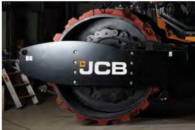
Быстрая и удобная установка сегментов кулачковых накладок (3 сегмента). Комплект включает скрепки.
