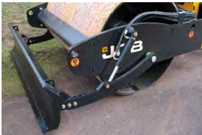
Отвал для выравнивания грунта.
