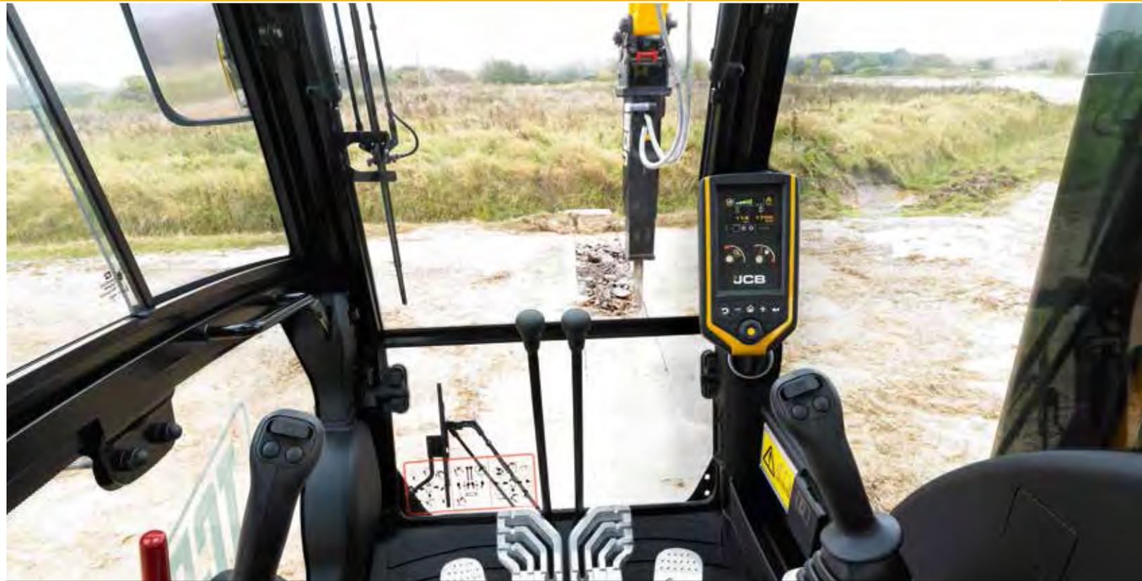
Разделение лобового стекла в соотношении 70/30 обеспечивает операторам машин JCB JS115/130/145 превосходную обзорность вперед.
