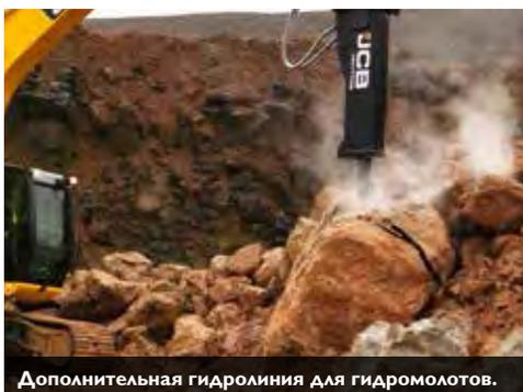
Дополнительная гидрوليния для гидромолотов.
