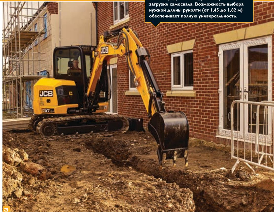
Ковш поворачивается на 181°, что позволяет отлично удерживать грунт во время загрузки самосвала. Возможность выбора нужной длины рукояти (от 1,45 до 1,82 м) обеспечивает полную универсальность.
