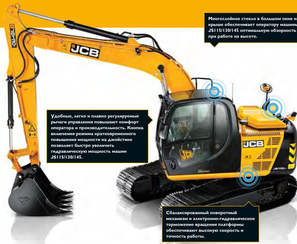
Удобные, легко и плавно регулируемые рычаги управления повышают комфорт оператора и производительность. Кнопка включения режима кратковременного повышения мощности на джойстике позволяет быстро увеличить гидравлическую мощность машин JSI 15/130/145.
