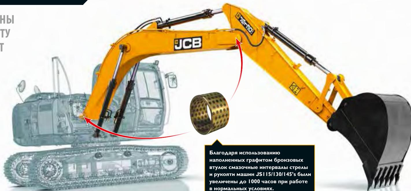
Благодаря использованию наполненных графитом бронзовых втулок смазочные интервалы стрелы и рукояти машин JS115/130/145's были увеличены до 1000 часов при работе в нормальных условиях.
