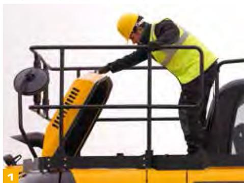
**1** Капот экскаваторов JS115/130/145 открывается спереди назад, что обеспечивает удобный и безопасный доступ для обслуживания двигателя.
